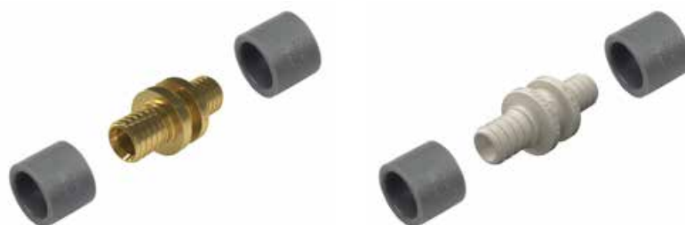
Obr. 49. Spojka KAN-therm ultraLINE k trubkám PEXC, PERT 2 a PERTAL 2 o průměrech 14 × 2, 16 × 2,2, 20 × 2,8, 25 × 2,5 mm.
