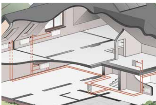
„Stoupačkový“ rozvod otopné soustavy
