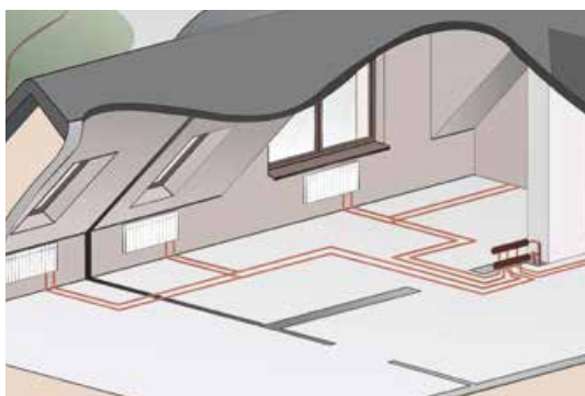
Rozvod otopné soustavy s rozdělovačem a větvemi
